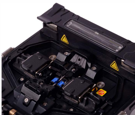
真正6马达纤芯对准 金属夹具，新型V槽设计
